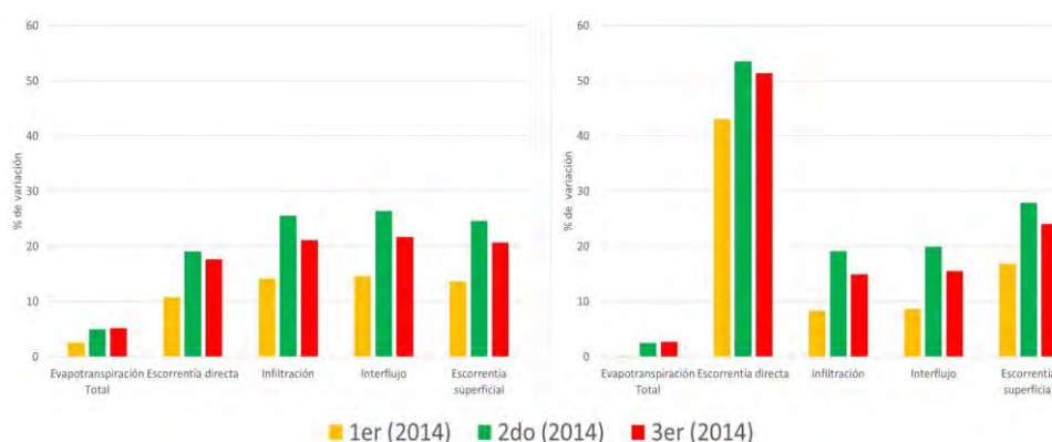
Figura 9-1. Variación de flujos con respecto del periodo de control bajo la trayectoria RCP 4.5 Izquierda, escenarios de cambio climático Derecha, escenarios de cambio climático y cambio de usos de suelo
